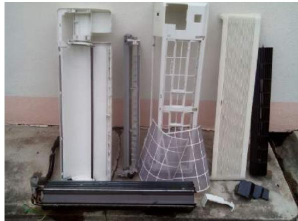
Setelah semua komponen dibersihkan, langkah seterusnya ialah mengeringkan komponen tersebut. Anda boleh menggunakan kipas penghembus (blower), mengelap komponen plastik dengan kain lap atau membiarkan seketika supaya ia kering.
